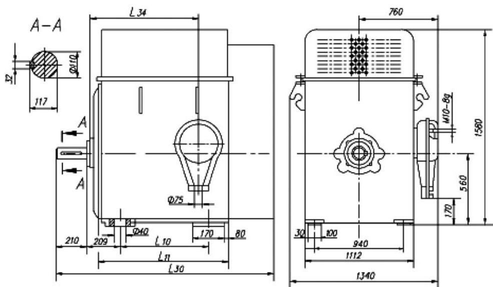
**Электродвигатели асинхронные с короткозамкнутым ротором серии ДАЗО 12-го и 13-го габарита, 50 Гц**
